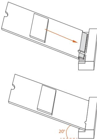
將 M.2 SSD 對準 M.2 插槽並輕輕插入。請注意，M.2 SSD 只能朝一個方向安裝。
