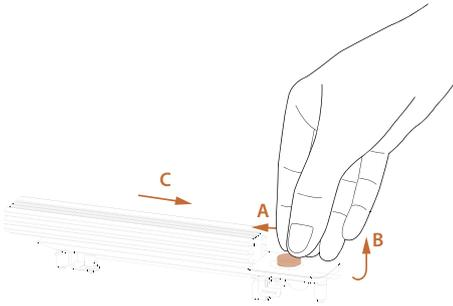
按下 M.2 散熱片上的按鈕，依照圖中所示方向 (A) 操作。然後，提起散熱器 (B) 並朝圖示 (C) 所示方向移動。
