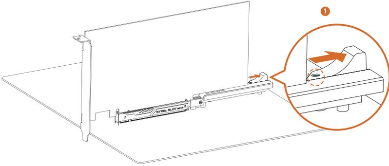
1. 將門鎖往右滑，將顯示卡從 PCIe 插槽中釋放。
