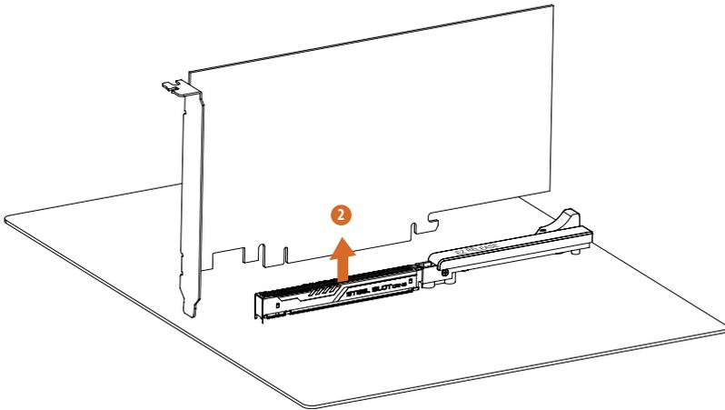
2. 您現在可以輕鬆從 PCIe 插槽拆下顯示卡。
