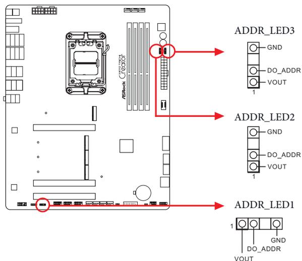
將可定址 RGB LED 燈條連接至主機板上的可定址 LED 排針 (ADDR\_LED1 / ADDR\_LED2 / ADDR\_LED3)。
